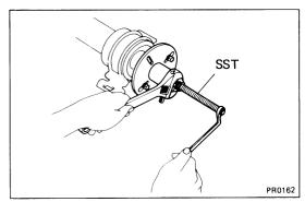
(d) Using SST, remove the flange from the intermediate shaft.
